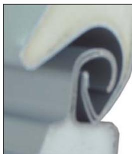
Направляющая шина имеет толщину 1,5 - 2 мм, сделана из оцинкованной стали в форме "Ω" и имеет специальный алюминиевый профиль с полоской – щеткой. Специальная насадка из ПВХ облегчает плавное и бесшумное движение рольставни и защиту от трения.
