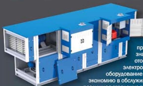
**Воздухонагреватели ВТР** имеют модульную конструкцию и могут состоять из одного (непосредственно самого воздухонагревателя) или нескольких модулей, количество и состав которых подбирается в зависимости от функции, которую должен выполнять ВТР в процессе работы (например, очистка, охлаждение, утилизация тепла и т. д.).
